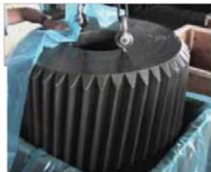
Thomas Simone社提供 実施製品: VpCI-126, VpCI-369D 製紙ギア, VpCI-369Dを塗布し, VpCI-126 ブルーで梱包。 実施場所, オハイオ USA
