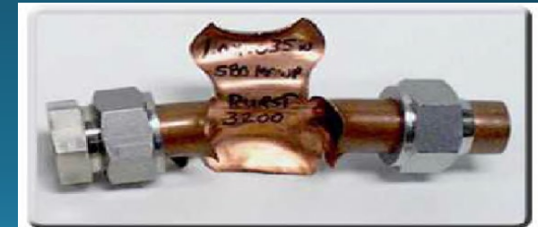
ガス管の気密試験での破損
