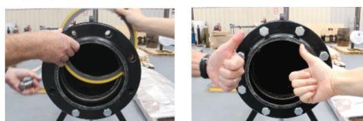
写真22 ガスケットの装着
